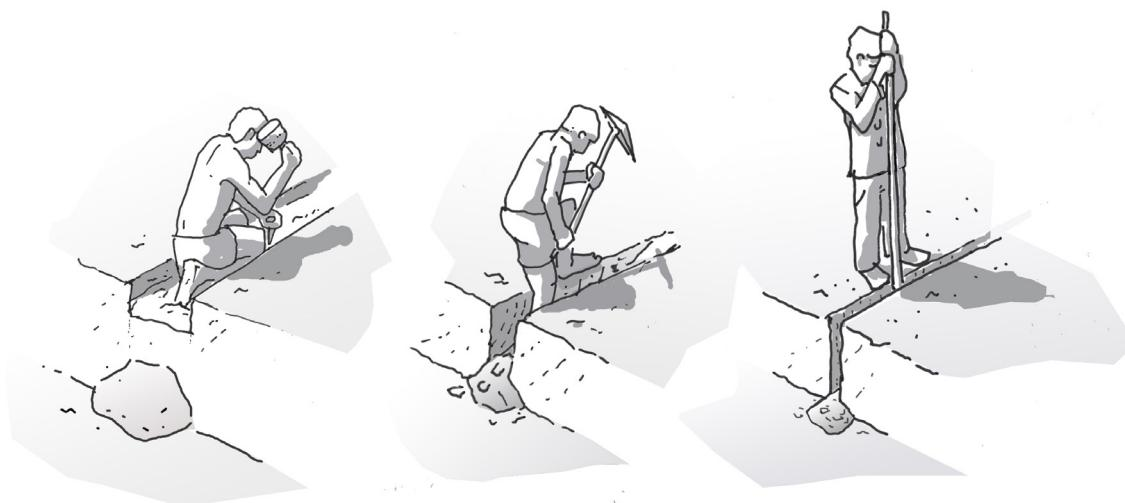
**Fig. 5.** Évolution de la technique du havage de l'Ancien Empire à nos jours : le développement d'outils de plus en plus longs et résistants a permis d'optimiser le creusement des tranchées qui se sont progressivement réduites en largeur. 1) Le ciseau et le maillet à l'Ancien Empire, 2) le pic de carrier (ou escoude) à la Période Romaine, 3) l'aiguille en acier durant la période moderne. Cette évolution met en lumière une réduction progressive des déchets de taille.
